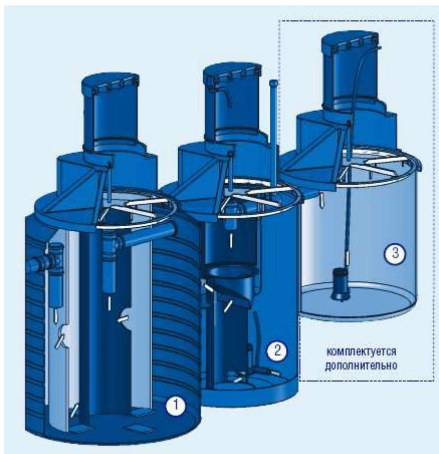
1 – отстойник; 2 – аэратор;
