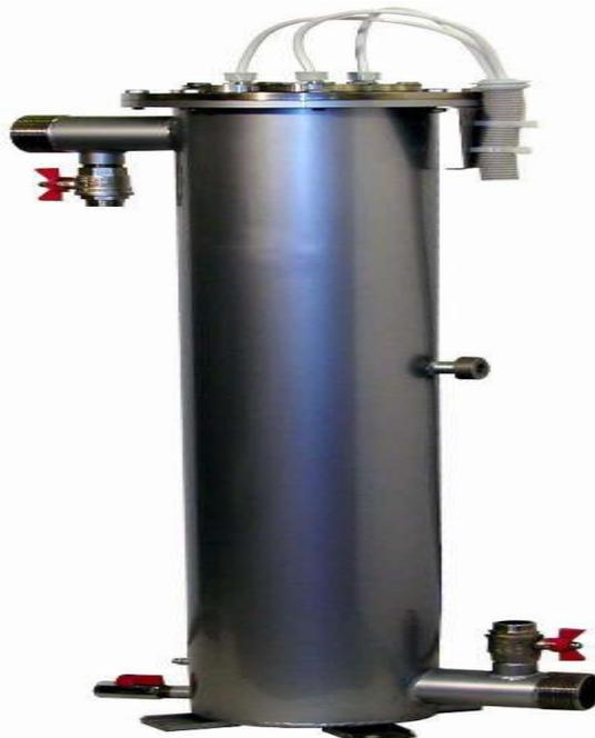
Источником лучей ультрафиолета являются ртутные лампы, находящиеся в чехле из кварцевого стекла, которые в свою очередь устанавливаются в корпусе из нержавеющей стали. Кварцевые чехлы свободно пропускают ультрафиолетовые лучи и необходимы для защиты ламп от контакта с водой. Собственно обеззараживание воды происходит при воздействии ультрафиолетового излучения на воду, протекающую внутри корпуса между кварцевыми чехлами.
